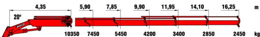
a6 16,40 m max. hydraulische Reichweite ( Arm gestreckt / max. outreach (horizontal position)
